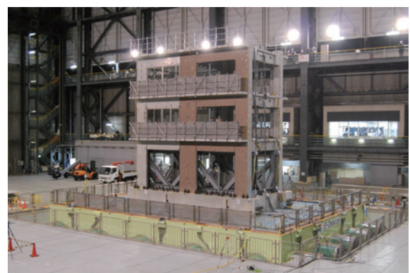
災害拠点建物の災害時機能継続性検証のため、令和元年12月に実施した3階建て鉄筋コンクリート造建物試験体のEーディフェンス振動台実験の様子（写真提供：防災科学技術研究所（NIED））
